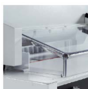
ฝารอบช่วยป้องกันอันตราย ทำให้ปลอดภัยในการตัดทุกครั้ง
