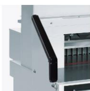
IR Light Beam เซ็นเซอร์อัจฉริยะ ที่มาแทนฝาครอบหน้าเครื่อง ทำให้ปลอดภัยในการตัดทุกครั้ง
