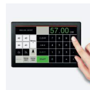
EASY-TO-USE TOUCH PAD หน้าจอรุ่นใหม่ระบบสัมผัส ขนาด 7" ตั้งโปรแกรมการตัดได้ 99 โปรแกรม
