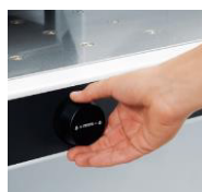
ELECTRONIC HAND WHEEL มือหมุนปรับระยะสามารถ ตั้งค่าโดยระบบ manual ได้
