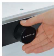
ELECTRONIC HAND WHEEL มือหมุนปรับระยะสามารถ ตั้งค่าโดยระบบ manual ได้
