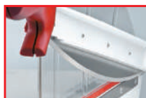
แผ่นการ์ดป้องกัน แผ่นป้องกันอันตรายจากใบมีด
