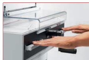
ACTIVATING BARS เป็นสำหรับกดตัดกระดาษ รุ่นใหม่ ใช้งานง่าย
